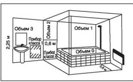
**Объем защиты** Этот прибор может быть установлен в объеме 2 или 3 при условии, что электрическое питание будет защищено устройством защитного отключения (УЗО), равным 30 мА.
